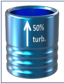
Abb. 7: Referenznormal mit Markierung
